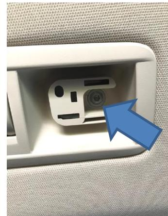
Dann die Stange in den rechten Halter schieben und danach im linken Halter einschieben. Jetzt die Schraube im linken Halter montieren.
