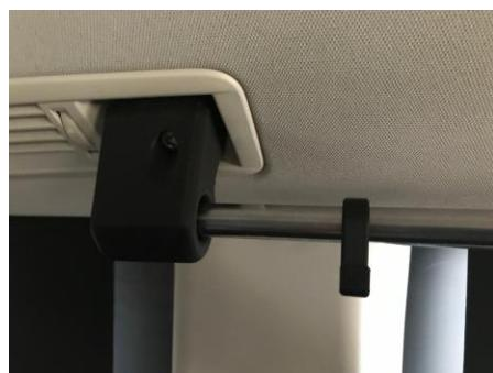
Um die mitgelieferte Box zu montieren, einfach die beiden Halter so auf die Stange drücken, dass sie Nasen nach außen stehen, dann die Box aufstecken und die Halter nach außen schieben.
